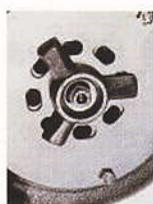
Pompa sommersibile per acque luride contenenti fibre lunghe; lo speciale sistema di triturazione unitamente alla rotazione del motore permette di ottenere una polverizzazione ottimale di qualsiasi corpo solido distruttibile aspirato e la rende particolarmente indicata in ambienti agricoli, industrie tessili, cantieri edili, stazioni di pompaggio in ambienti civili e con acque di scarico civili e industriali.
