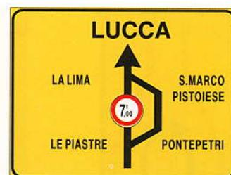
FIG. 408 ART. 43 PREAVVISO DI DEVIAZIONE
