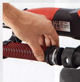
Facile collegamento del tubo di aspirazione alla WSE 7 Vario con il sistema Flex-Clip
