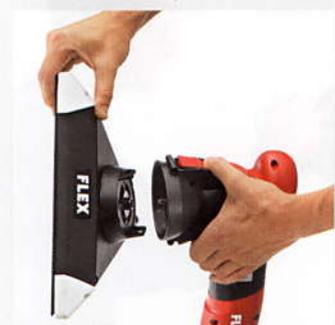
Sostituzione della testa di levigatura con un semplice movimento, per la lavorazione di bordi ed angoli. Premere semplicemente i due arresti sul supporto e la testa può essere rimossa con un clic.
