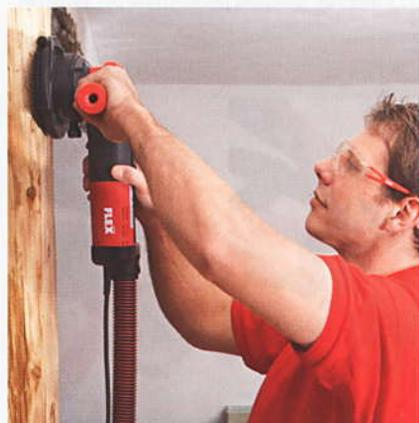
La **RETECFLEX** in abbinamento al platorello a strappo con dischi abrasivi si presta efficacemente anche alla rimozione e all'aspirazione di vecchie pitture dal legno.
