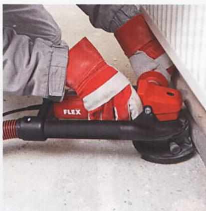
Efficiente sistema di aspirazione anche operando con il segmento totalmente aperto.
